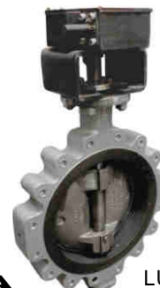
VÁLVULA MARIPOSA DISCO INOX 316 DOBLE/TRIPLE EXCENRICIDAD
